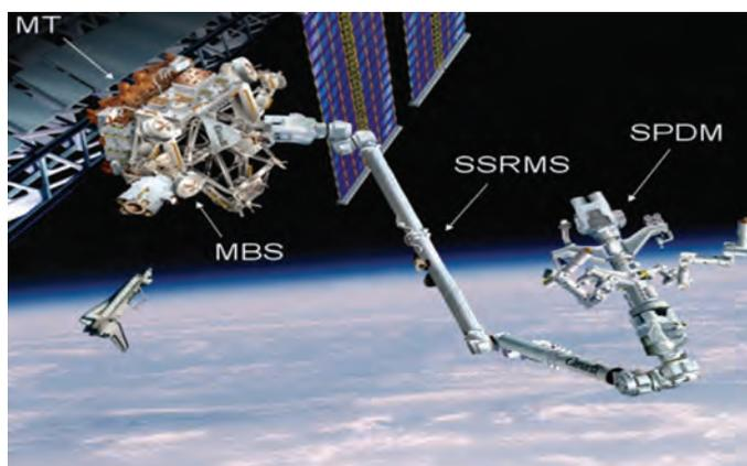
Рис. 2. Мобильная система обслуживания (MSS)
