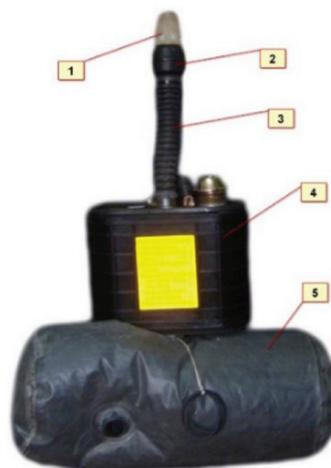
Рис. 3. Имитатор самоспасателя
