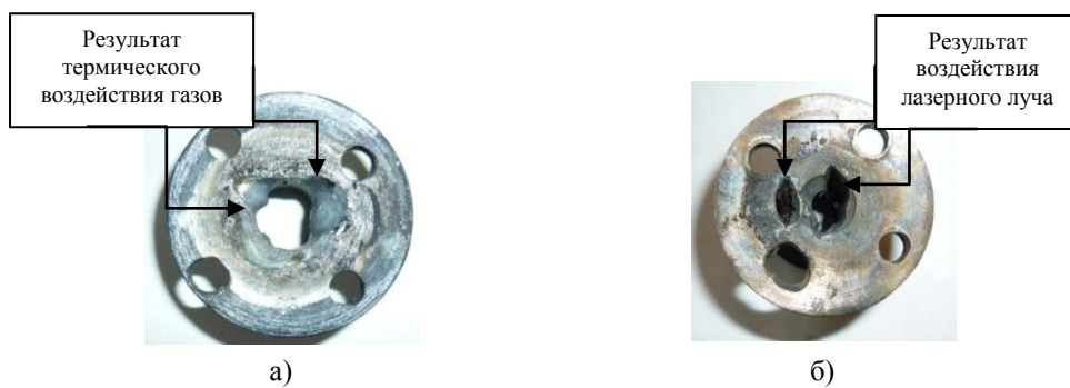
Рис. 15. Сравнение деталей экспериментальных ЛРД после «огневых» испытаний (область критического сечения)
