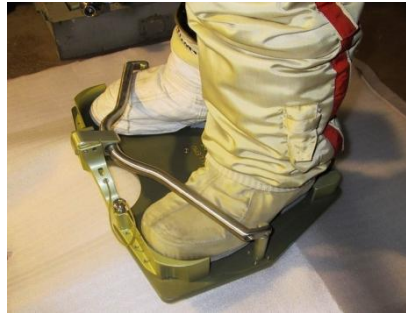
Рис. 5. Гибридное устройство «Якорь», фиксирующее ботинки российского скафандра «Орлан» и американского скафандра EMU
