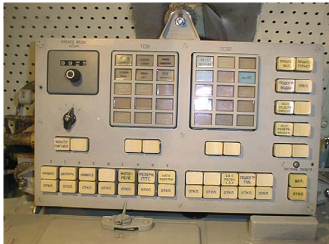
Рис. 2. Пульт бытового отсека (ПБО)
