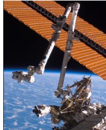
Рис. 1. Манипулятор SSRMS на подвижной платформе
