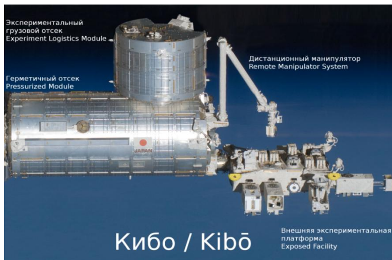
Рис. 4. Робототехнический комплекс JEMRMS на модуле KIBO
