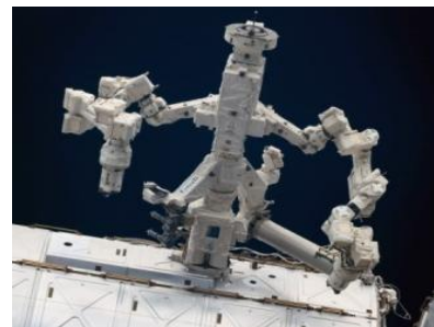
Рис. 3. Манипулятор специального назначения SPDM
