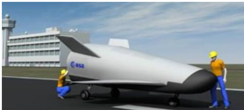
Рис. 2. Внешний вид перспективного европейского АКА-О ISV, предназначенного для выполнения ТОР КА на околоземных орбитах
