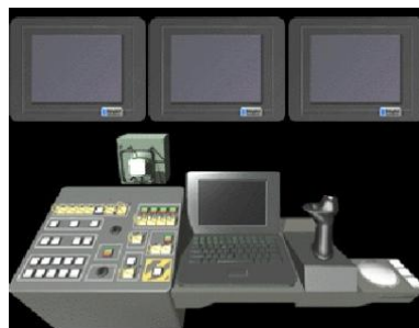
Рис. 2. Рабочая станция RWS. Органы управления SSRMS и SPDM
