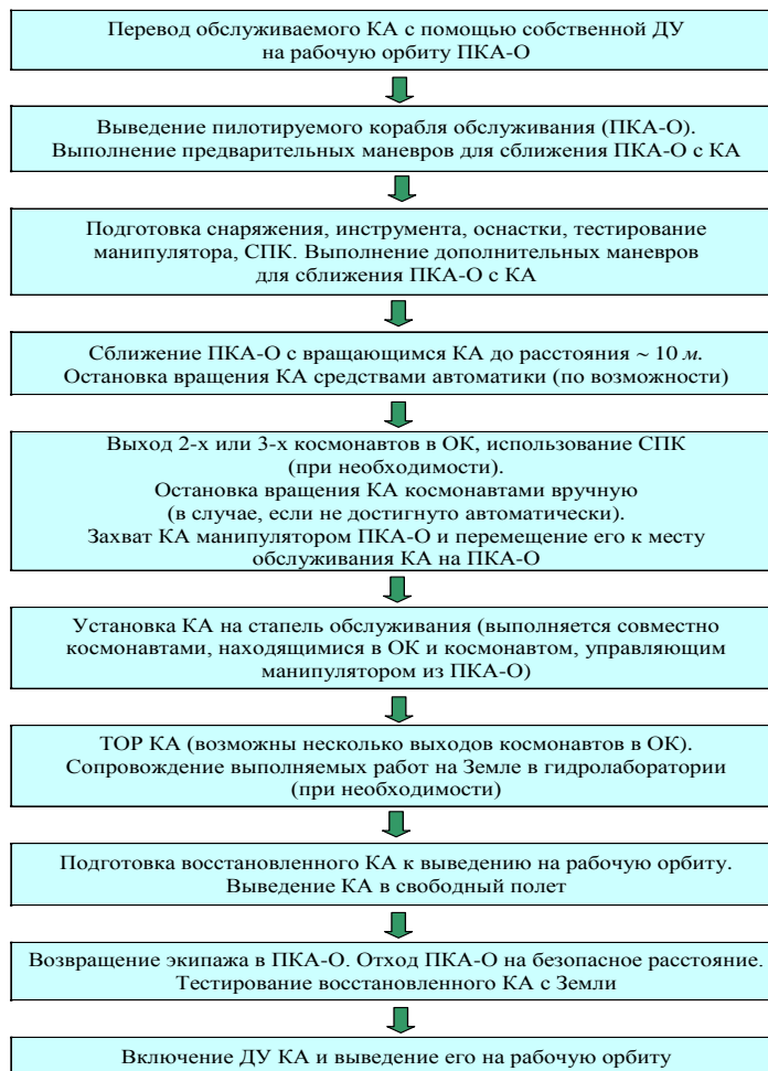
Рис. 6. Последовательность операций обслуживания КА на орбите ПКА-О
