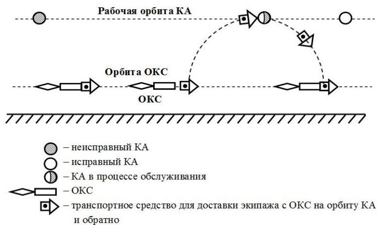
Рис. 9. Обслуживание КА на его рабочей орбите экипажем ОКС
