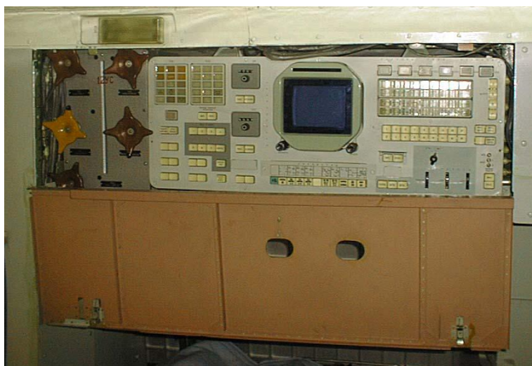
Рис. 3. Пульт предшлюзового отсека (ППШО)
