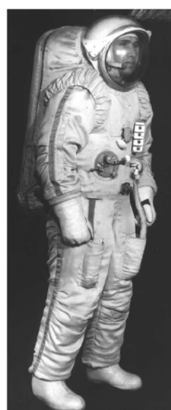
Рис. 11. Общий вид скафандра «Орлан» (для лунной программы)
