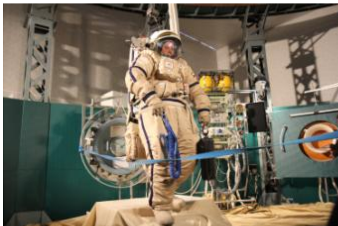
Рис. 11. Моделирование напланетной деятельности в условиях пониженной весомости в скафандре на тренажере «Выход-2»
