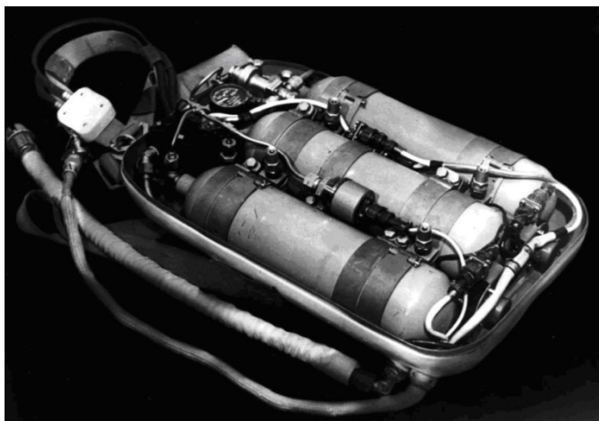
Рис. 4. Ранцевая система скафандра «Беркут» (крышка снята)
