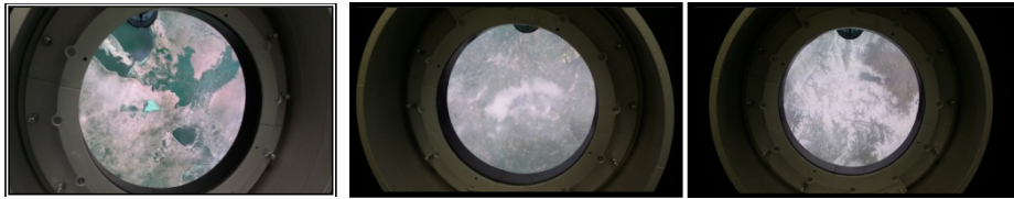
Рис. 3. Примеры изображений поверхности Земли через иллюминатор тренажера «ВИН» с вариантами маскирующих факторов
