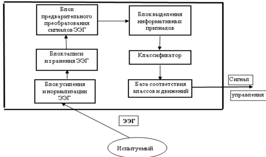
Рис. 1. Блок-схема интерфейса «мозг-компьютер»
