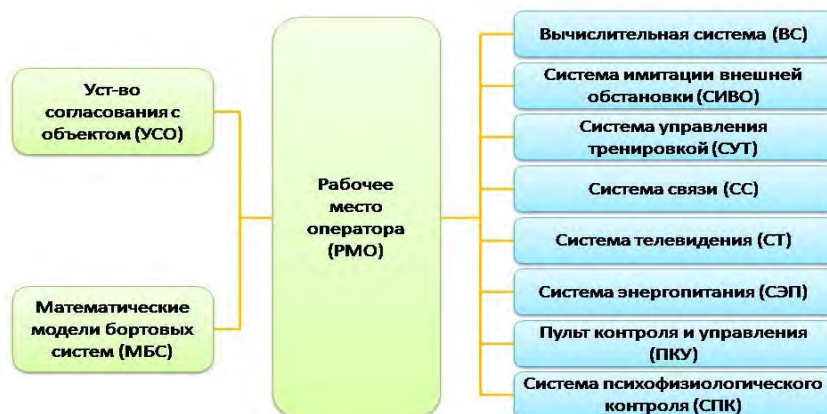
Рис. 1. Вариант декомпозиции тренажера на структурные модули
