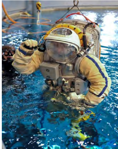
Рис.1. Модернизированный скафандр для тренировок космонавтов в гидросреде
