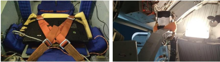
Рис. 7. Размещение ноутбука и ШВР в кабине ЦФ-18
