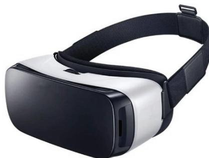
Рис. 5. Шлем виртуальной реальности
