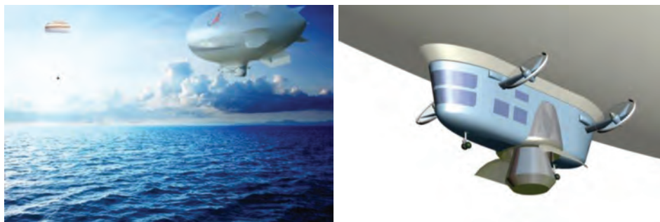
Рис. 2. Метод буксировки спускаемого космического аппарата в гондole при проведении спасательной операции с использованием дирижабля
