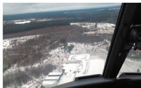
Фото 2. Снижение по глиссаде: H = 100 \text{ м} , D = 400 \text{ м} , V = 80 \text{ км/ч} , V_y = 2 \text{ м/с}
