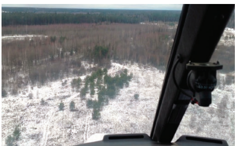
Фото 3. Снижение по глиссаде: H = 50 \text{ м} , D = 200 \text{ м} , V = 80 \text{ км/ч} , V_y = 2 \text{ м/с}
