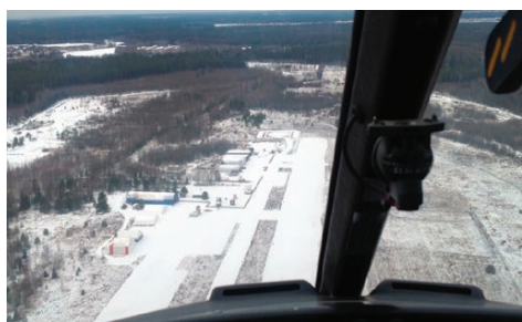
Фото 1. Вход в глиссаду: H = 150 \text{ м} , D = 600 \text{ м} , V = 80 \text{ км/ч} , V_y = 0 \text{ м/с}
