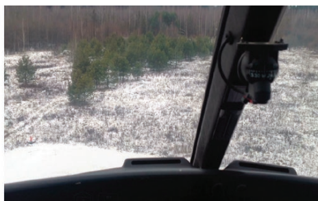
Фото 4. Зависание над точкой посадки: H = 5 \text{ м} , D = 0 \text{ м} , V = 0 \text{ км/ч} , V_y = 0 \text{ м/с}
