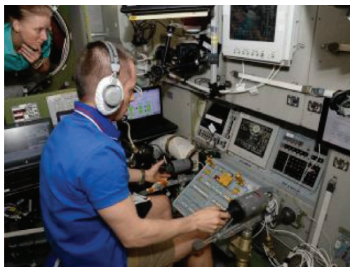
Рис. 3. Космонавт Сергей Рыжиков выполняет стыковку ТГК «Прогресс МС-16» с МКС в режиме ТОРУ
