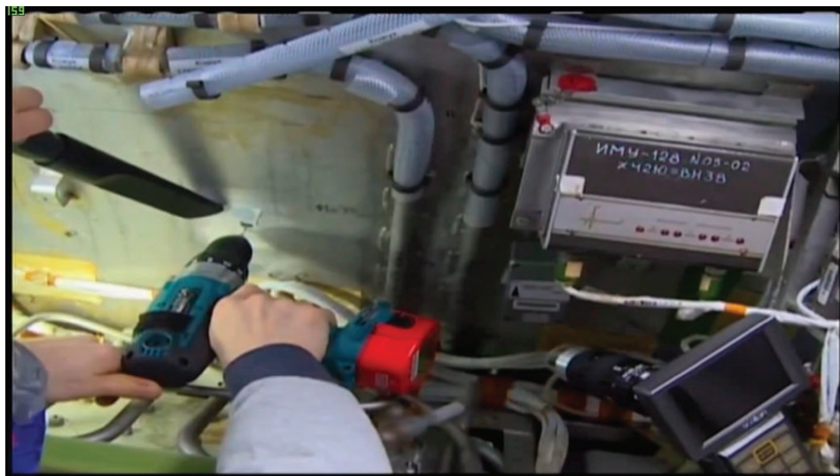
Рис. 2. Локализация трещины ПрК СМ РС МКС
