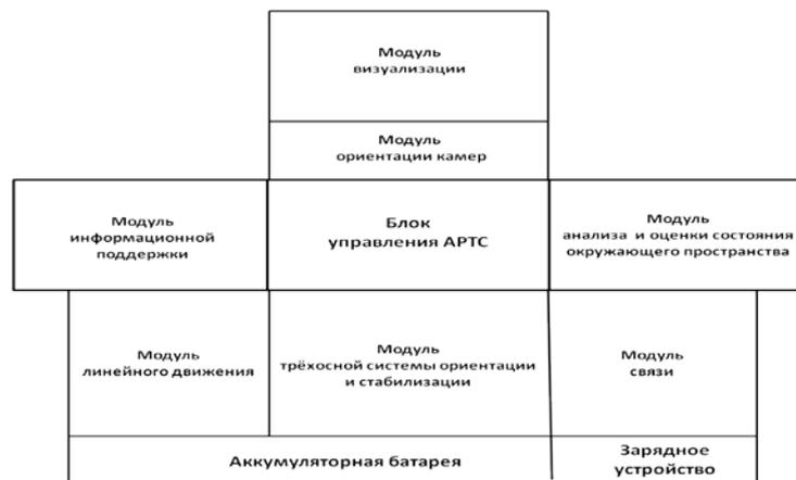
Рис. 2. Состав взаимодействующих модулей базового блока мобильного АР КН, способного функционировать в автоматическом и интерактивном копирующем режимах
