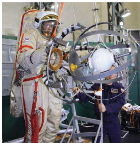
Рис. 1. Имитация запуска тестового спутника сферической формы «ТС530-Зеркало» с помощью пускового устройства
