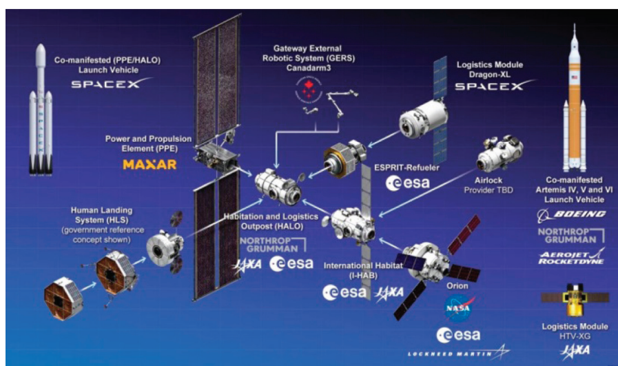
Рис. 14. Конфигурация станции по состоянию на 16 ноября 2022 г., НАСА
