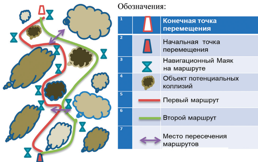
Рис. 4. Состав информационного кадра – фрагмент маршрута на дорожной карте для определения позиционирования ЛР
