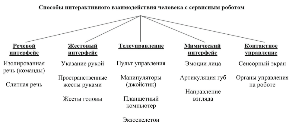
Рис. 6. Варианты построения интерфейсов интерактивного взаимодействия космонавта с РТС
